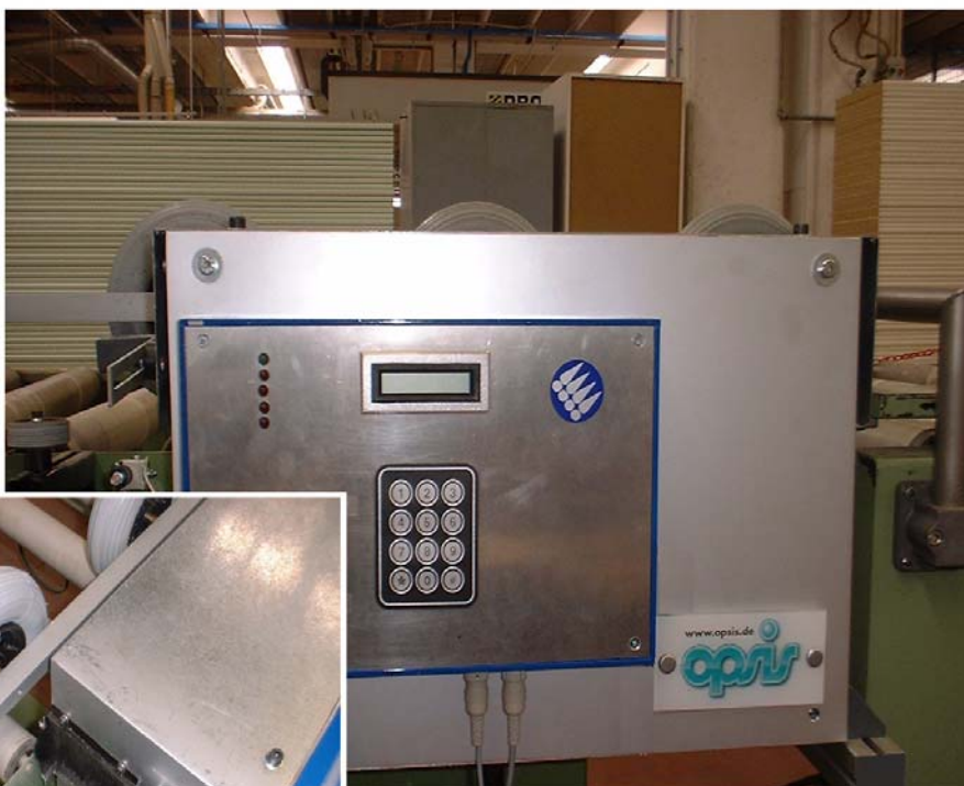
EDGEchecker an der Kanten-Maschine (oben) Ink-Jet-Einheit zur Fehler-Markierung (links)
