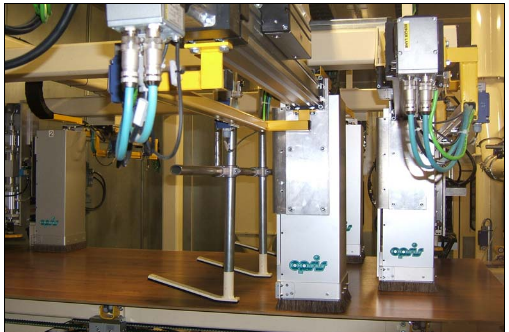
4-Kamera-System in der Sägen-Linie
