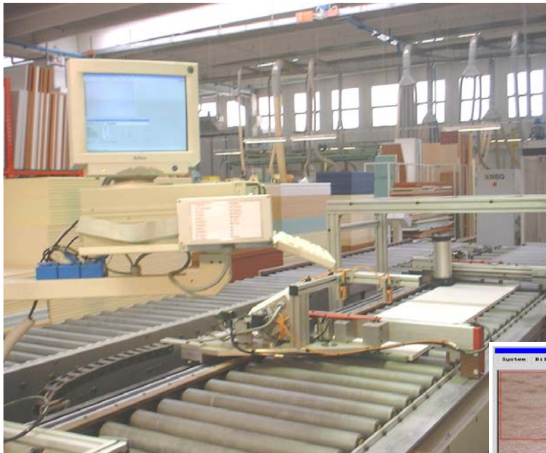
WOODchecker in der Möbelplatten-Produktion (oben) Bildschirmdarstellung der Maserungs-Erkennung (rechts)
