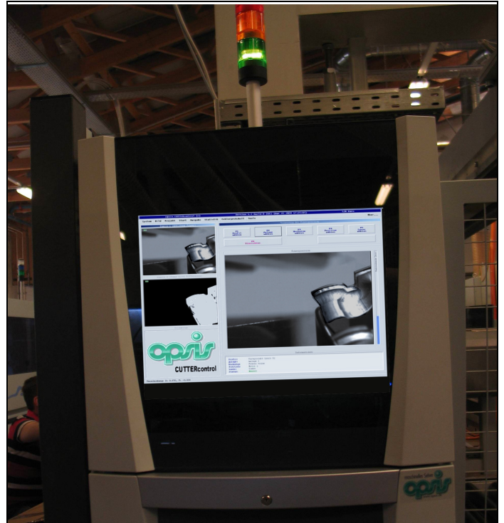
Elektronik-Schaltschrank mit Bediener-Führung für beidseitige stationäre Aufstellung (alternativ mobile Variante lieferbar)
