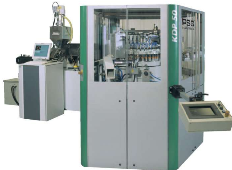
Le CAPchecker® d'opsis en exécution standard, monté dans la PSG Inshell Liner Moulding Machine chez PackSys Global, Suisse
