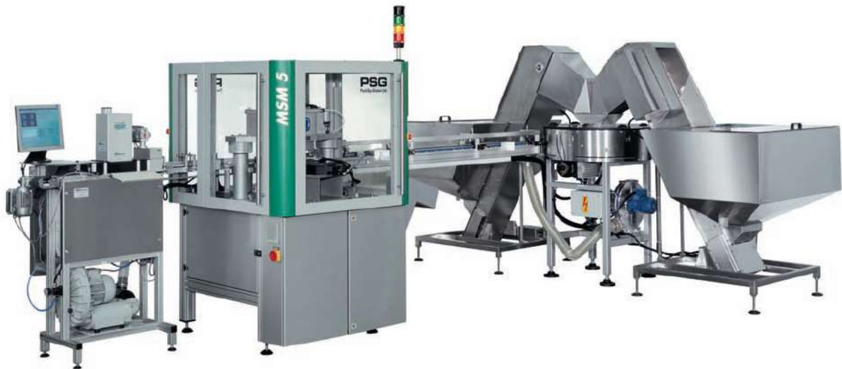
Le CAPchecker® d'opsis en exécution standard, monté dans la PSG Slitter Machine chez PackSys Global, Suisse,
